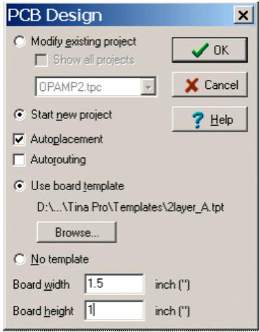
Wählen Sie “Neues Projekt beginnen”, “Automatische Platzierung” und “Leiterplatten-Vorlage benutzen”. Suchen Sie mit der Schaltfläche Durchsuchen die Vorlagen-Datei 2layer\_A.tpt in den Vorlagen von ELECTINA und wählen Sie sie aus. Die Einstellungen eignen sich für eine doppelseitige gedruckte Leiterplatte.
