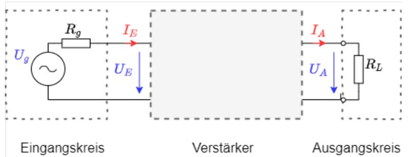
Bei den meisten Anwendungen wird ein Spannungsverstärker benötigt. Entsprechend wird dieser für die folgende Erklärung zu Grunde gelegt. Die ermittelten Größen gelten aber entsprechend für andere Verstärker. In [Abbildung 2](#) ist ein Spannungsverstärker als Blackbox abgebildet. Der Spannungsverstärker versucht stets ein vorgegebenes Vielfaches der Eingangsspannung  $U_E$  am Ausgang als Ausgangsspannung  $U_A$  auszugeben. Dieses „Vielfache“ kann als Verhältnis ermittelt werden.
