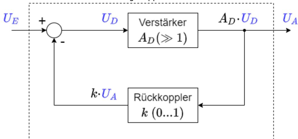
Zum Prinzip der Gegenkopplung war im Skript das nebenstehende Blockschaltbild gegeben. Dabei ist  $A_D$  die sogenannte Differenzverstärkung, also die Verstärkung der Differenz aus Eingangsspannung  $U_E$  und rückgekoppelter Spannung.
