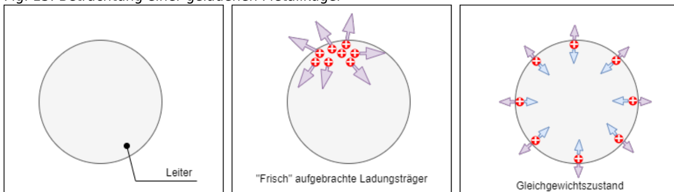
Fig. 13: Betrachtung einer geladenen Metallkugel
