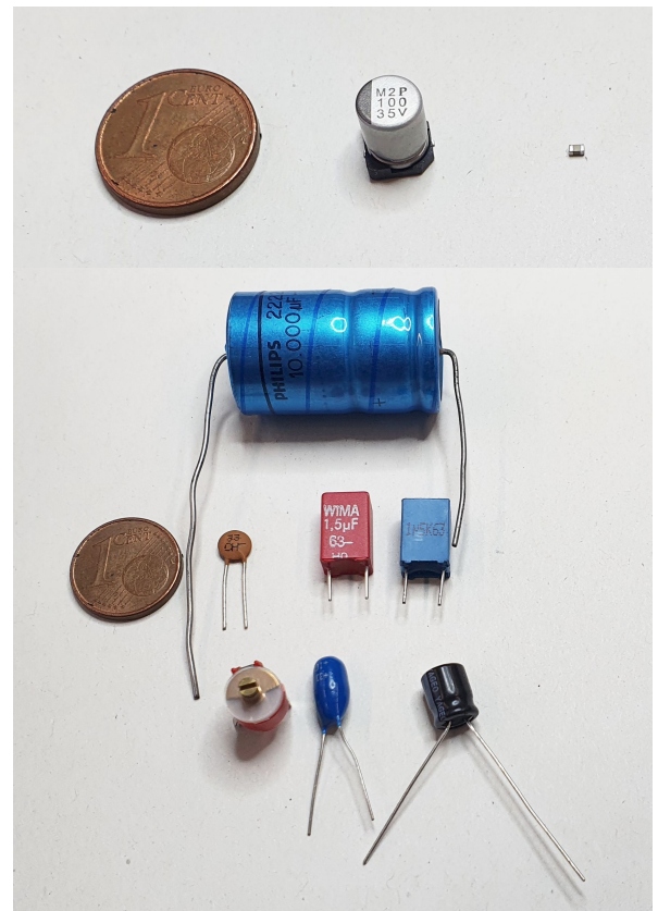
Fig. 18: Bauformen von Kondensatoren
