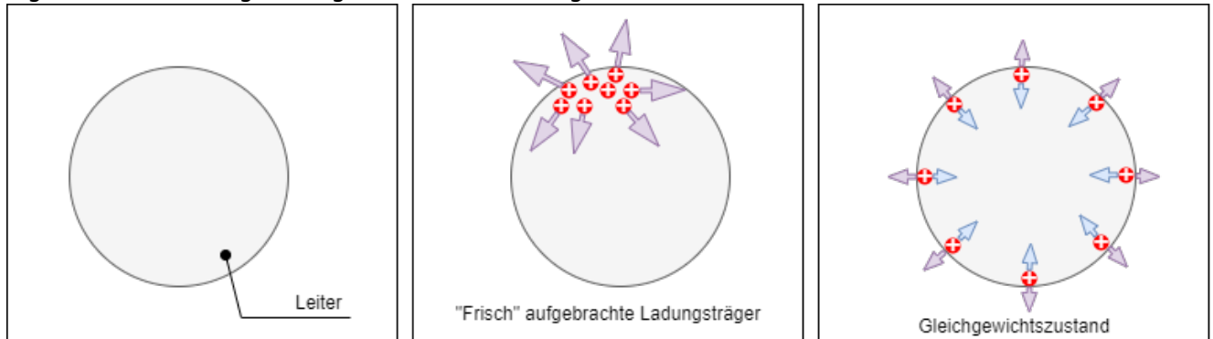
Fig. 13: Betrachtung einer geladenen Metallkugel
