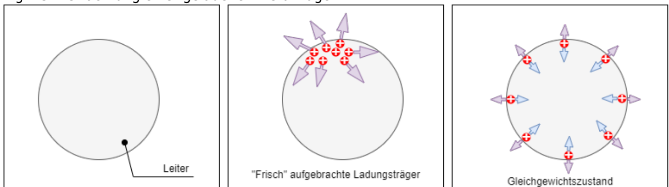
Fig. 13: Betrachtung einer geladenen Metallkugel
