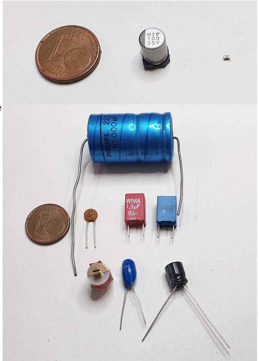
Fig. 18: Bauformen von Kondensatoren
