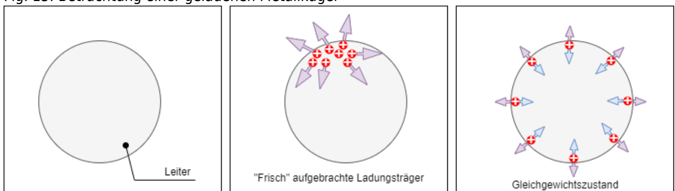
Fig. 13: Betrachtung einer geladenen Metallkugel
