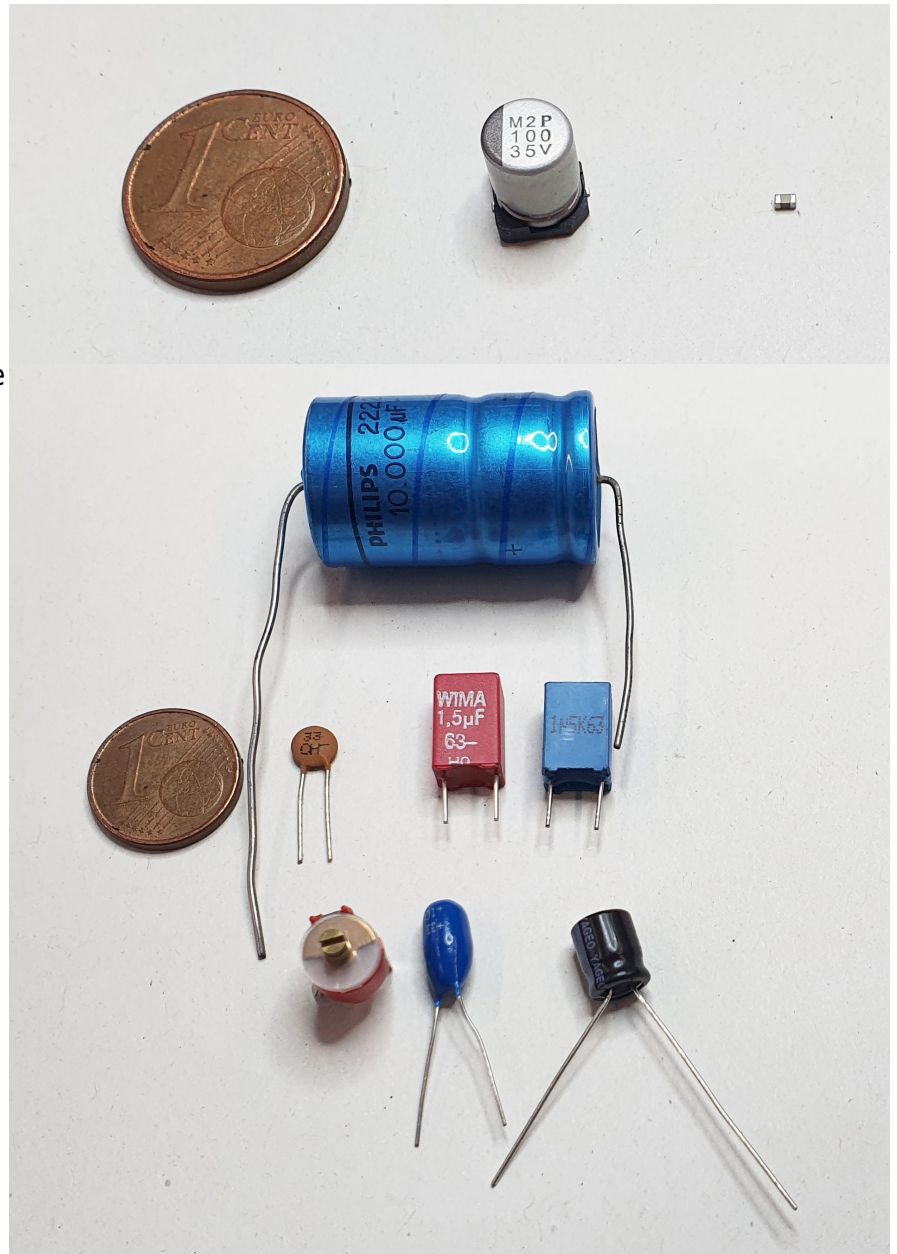
Fig. 18: Bauformen von Kondensatoren
