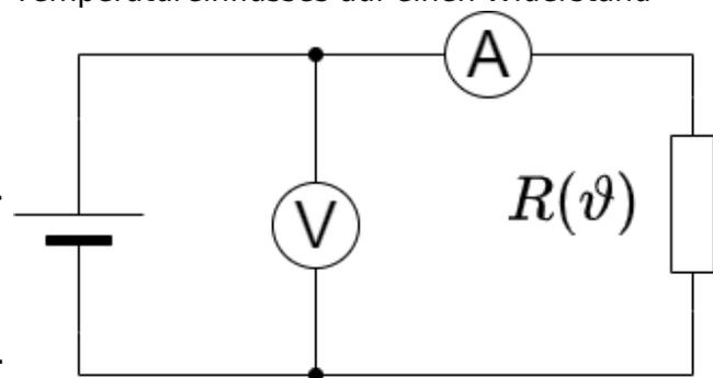
Abb. 15: Einfluss der Temperatur auf den Widerstand
