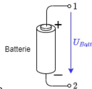
Abb. 10: Beispiel für die konventionelle Spannungsangabe
