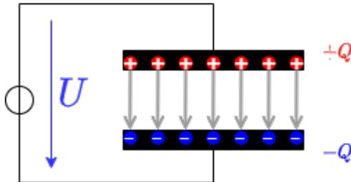
Im vorherigen Kapitel wurde bereits der Kondensator beschrieben. Er besteht aus zwei isolierten Leitern, die von einem Isolator getrennt sind (vgl. [Abbildung 1](#)). Sie dienen als Energiespeicher. Dies geschieht in folgender Art:
