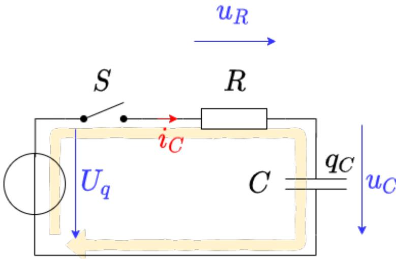
Um den Ladevorgang eines Kondensators zu verstehen, soll ein zunächst ungeladener Kondensator mit der Kapazität  $C$  über einen Widerstand  $R$  von einer Gleichspannungsquelle  $U_q$  geladen werden.
