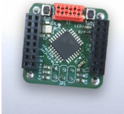
Fig. 1: fertige MMC 1x1 328PB Platine
