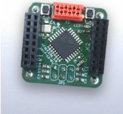
Fig. 1: fertige MMC 1x1 328PB Platine
