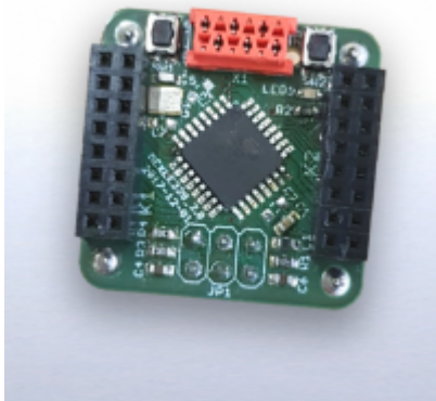
Fig. 1: fertige MMC 1x1 328PB Platine
