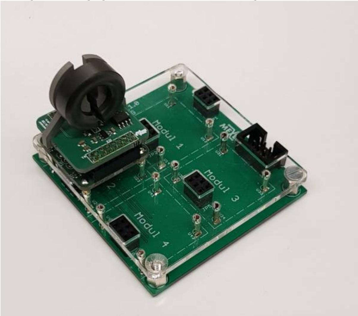
Stromsensor zur berührungslosen Messung bis 3A als Hookup auf einem Board mit ATmega328
