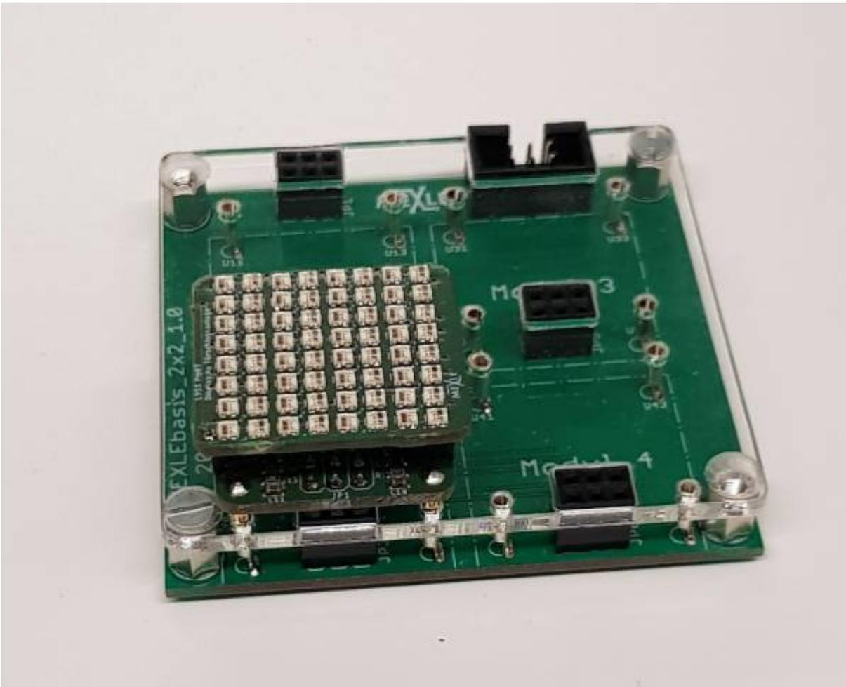
MEXLE Microcontroller Board mit selbst entwickeltem 8x8 Farb-LED Matrix (WS2812) auf 25x25mm<sup>2</sup>
