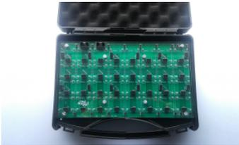
Die Konzeption der Hardware trägt der Flexibilität des Einsatzortes Rechnung. Aus diesem Grund wird ein kleiner handlicher Koffer verwendet, der ganzflächig mit einem Modulträger bestückt ist. Der Modulträger dient dabei sowohl als mechanischer Träger, wie auch zur elektrischen Verbindung der Module untereinander. Im Bild ist ein großer Modulträger für bis zu 4×8 Module zu sehen.
