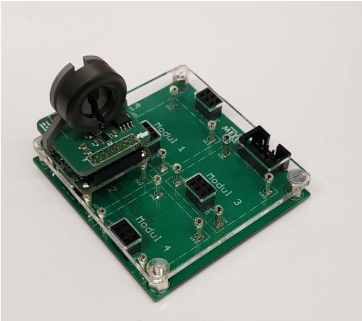
Stromsensor zur berührungslosen Messung bis 3A als Hookup auf einem Board mit ATmega328
