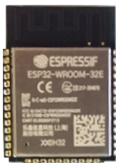
Fig. 3: Ausgewähltes Modul ESP32-WROOM-32E
