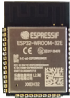
Fig. 3: Ausgewähltes Modul ESP32-WROOM-32E
