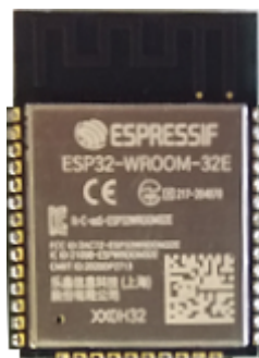
Fig. 3: Ausgewähltes Modul ESP32-WROOM-32E
