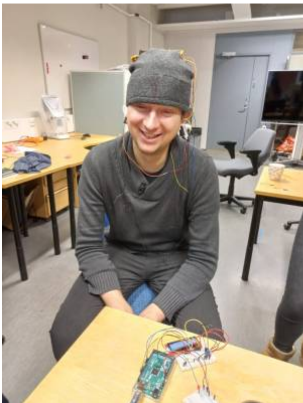
Fig. 1: Verwendung von in Kleidung eingebauten Elektroden an einem Probanden
